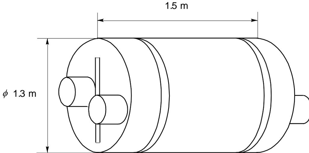
Fig. 3 2 m<sup>3</sup> scintillation detector
